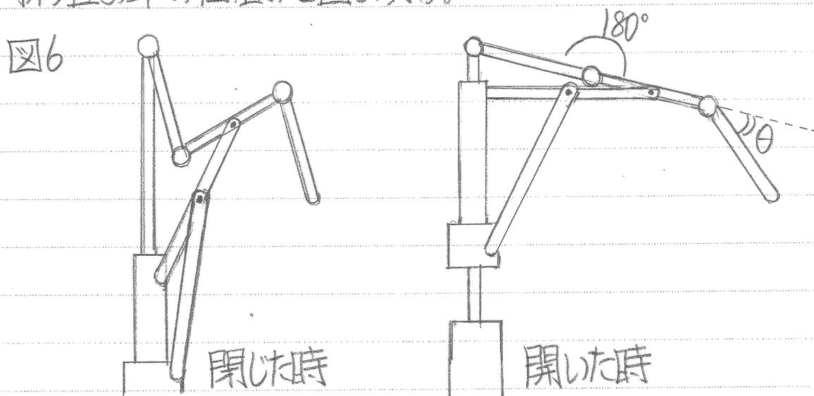
このように折り畳み傘ではこの研究で使った式である $Y/X = \tan 2\theta$ が使えないことが分かる。また、リブ接続部を補強するための構造に費用がかかるため、折り畳み傘に対して高価になる傾向がある。
